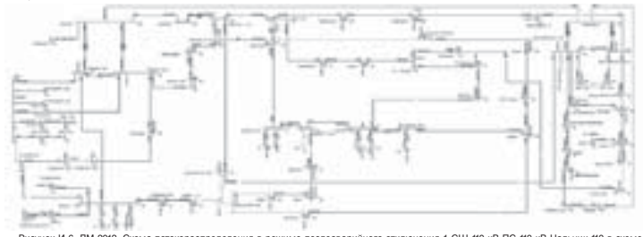
Рисунок И-6. ЛМ-2012. Схема потококораспределения в режиме послеварийного отключения 1 СШ 110 кВ ПС 110 кВ Нальчик-110 в схеме ремонта ВЛ 110 кВ ПТФ - Нальчик-Тяговая в период прохождения летнего максимума нагрузки 2012 года
